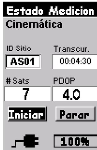
**Figura 3.68** Pantalla Estado de la Medición – Cinemática
