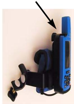
**Figura 3.11** Montaje de ProMark2 en la Abrazadera de Terreno.
