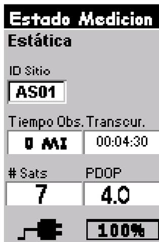
**Figura 3.40** Pantalla Estado de la Medición
