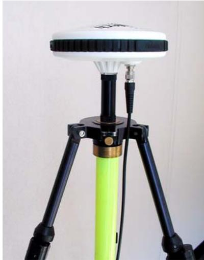
**Figura 1.15** Trípode GPS de Altura Fija con Extensión y Antena GPS
