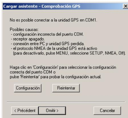
**Figura 1.19:** Mensaje de error de conexión ProMark2
