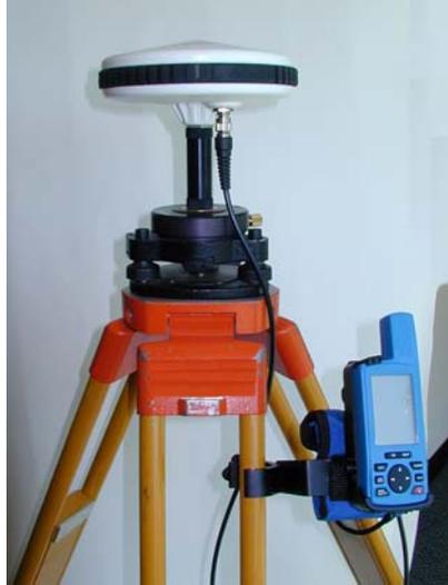
**Figura 3.12** Abrazadera de Terreno en Trípode
