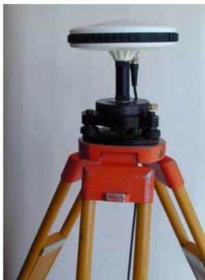
**Figura 3.10** Antena GPS Montada en Trípode utilizando Base Nivelante y Extensión
