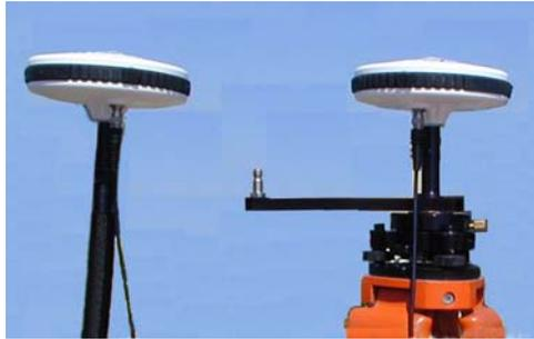
**Figura 3.28** Antena Rover desde Barra Inicializadora a Jalón
