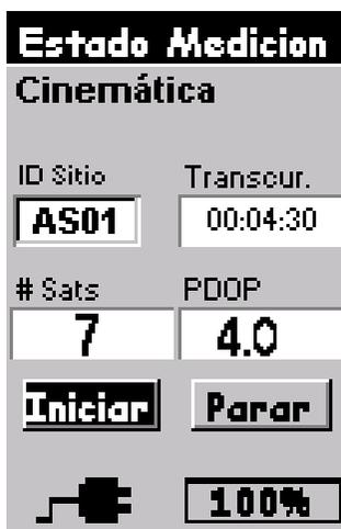
Figura 4.23 Pantalla Estado Medición - Cinemática
