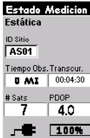
**Figura 3.25** Pantalla de Estado Medición
