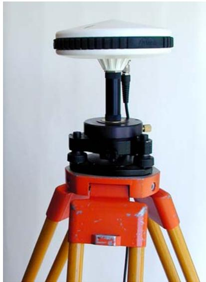
**Figura 1.12** Trípode, Base Nivelante y Adaptador para Base Nivelante
