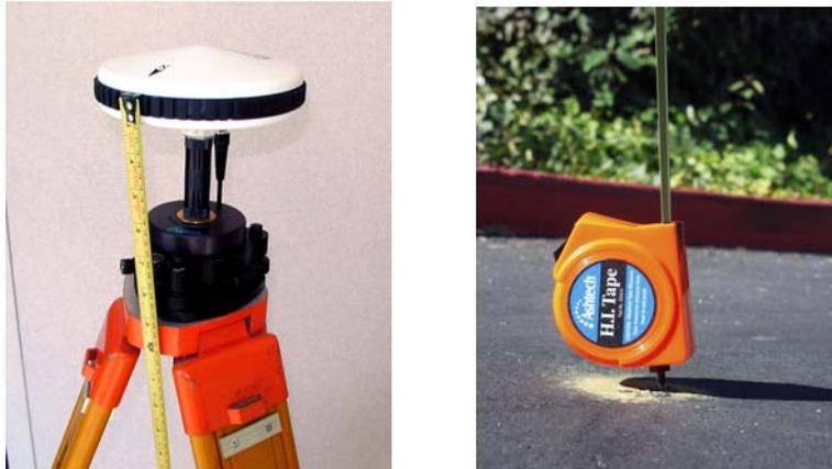
**Figura 3.14** Midiendo Altura de Instrumento
